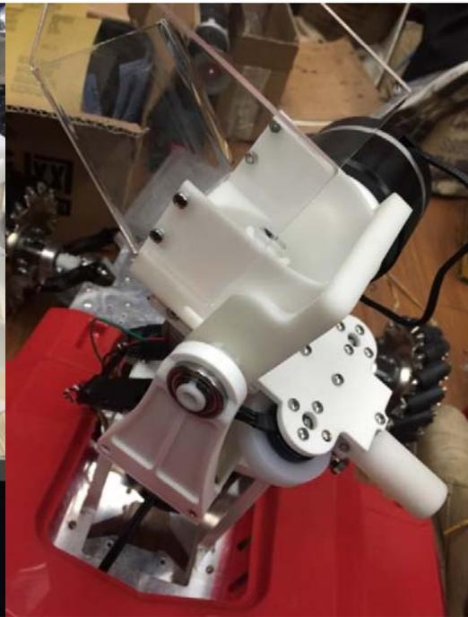
图 7-9 云台最终安装实物
