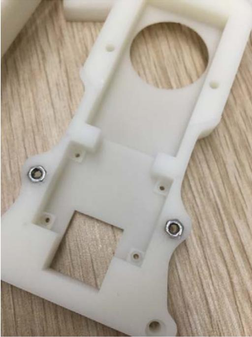
图 7-6 云台支撑实物
