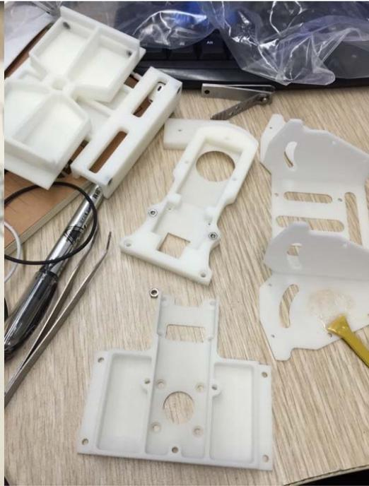
图 7-5 云台大部分 3D 打印成品
